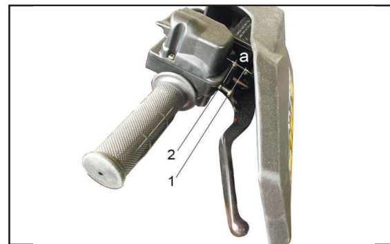
1. Šroub pro nastavení omezovače rychlosti. 2. Pojistná matice.
