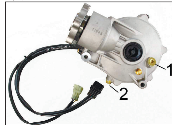
1. Nalévací šroub 2. Vypouštěcí šroub
